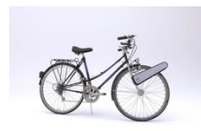
CLIP Motor-Clip, der ein Rad zum E-Rad macht
